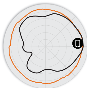
Figure 3 - Diagrammes d'antennes Azimut T310d 5 GHz
