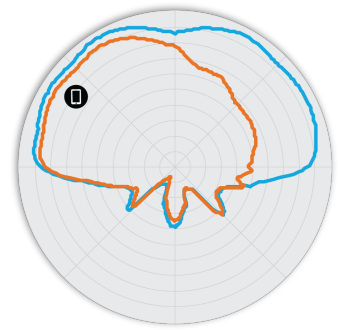
РИСУНОК 5 Вертикальная плоскость 5 ГГц R730 Диаграммы направленности антенны
